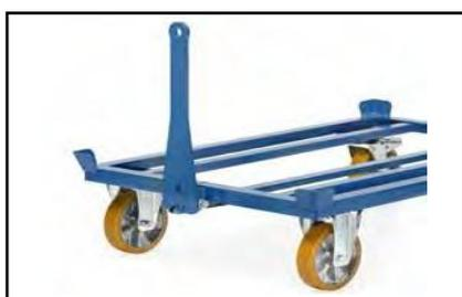
Timone di connessione in acciaio posto sul lato con le due ruote fisse. Occhiello per l'aggancio  $\varnothing$  26.5 mm. Aggancio semplice, anche con i piedi. Ritorno automatico del timone in posizione verticale, con molla a gas.
