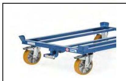
Robusto perno  $\varnothing$  25 mm posto sul lato con le due ruote pivottanti, con ganasce di guida e blocco di sicurezza automatico. Altezza di aggancio 205 mm.
