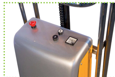
Vano impianto con indicatore stato batteria, pulsantisalita, discesa ed emergenza
