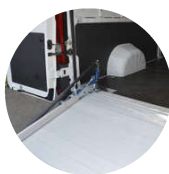
Bandella mobile che raccorda al piano
