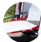
Bandella mobile che raccorda al piano
